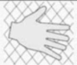
Schutz gegen großflächige Berührung mit der Hand, Schutz gegen Fremdkörper mit $\varnothing > 50$ mm                                | <b>1</b>         |
