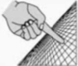
Schutz gegen Berührung mit den Fingern, Schutz gegen Fremdkörper mit $\varnothing > 12$ mm                                          | <b>2</b>         |
