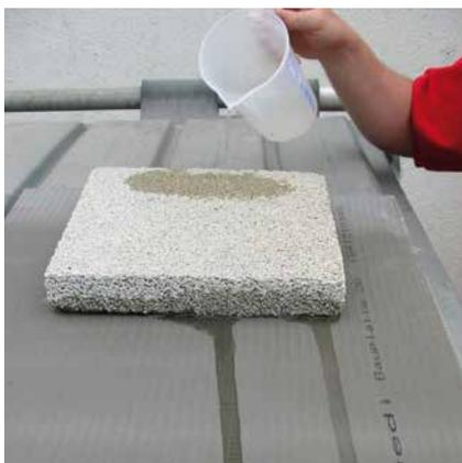
Leichter Wasserabfluss in einer Drainageestrich-Musterplatte.
