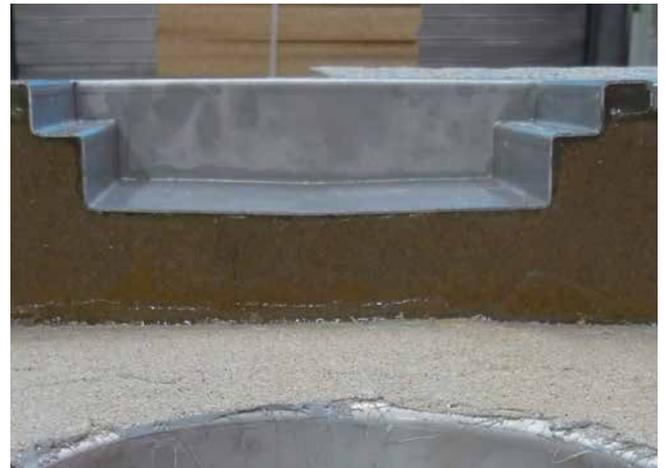
Sehr gut ist in dem Schnittmodell der kapillardichte Verguss unterhalb des Rinnenkörpers zu erkennen.
