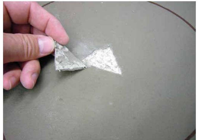
Herausgeschnittenes Abdichtungsstück zur Ermittlung der Schichtdicke.
