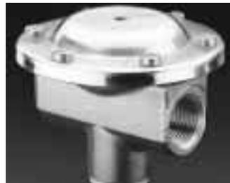
net sich für den Einsatz in Anlagen, bei denen der Tankfüllstand oberhalb des tiefsten Punktes der Saugleitung liegt. Bei Brennerstillstand sperrt ein federbelasteter Kolben die Saugleitung zwischen Tank und Anlage ab. Wird der Brenner eingeschaltet, wirkt der anliegende Unterdruck auf eine Membrane, die über einen Stößel den Sperrkolben anhebt.
