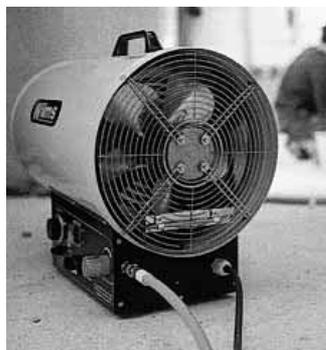
entweder Gas- oder Elektroheizgeräte eingesetzt. Beides in einem ist der neue „Duotherm“. Die Heizleistung beträgt im Gasbetrieb 14 bis 25 kW, im Elektrobetrieb 3 kW. Die Betriebsart kann jederzeit umgeschaltet werden. Eine Automatik schaltet selbsttätig auf Elektrobetrieb, wenn die Gasversorgung unterbrochen wird.
