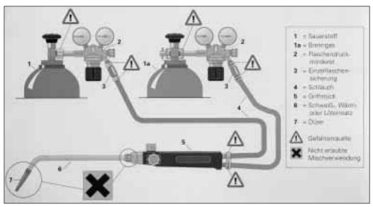
Beim Einrichten der Schweißanlage müssen die Verbindungen ordnungsgemäß festgezogen werden. Schweißdüse, Einsatz und Griffstück sollten immer vom gleichen Hersteller sein und zum gleichen System gehören (Bild: Messer Griesheim)
