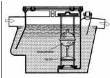
**Bei Leichtflüssigkeits-Abscheidern ist vor allem die Führung des Schwimmers sowie die Dichtigkeit des Ventils zu überprüfen**
