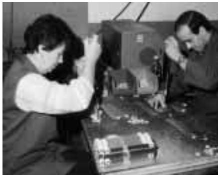
Mit zwei Kreissägen wird der Profilstab auf die exakte Länge gebracht, wobei auch Gehrungsschnitte möglich sind
