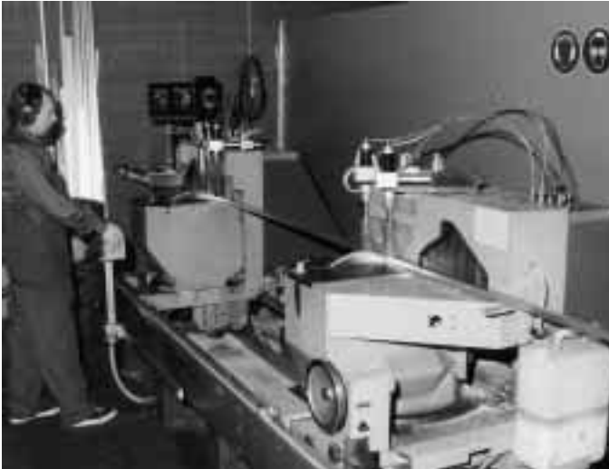
Mit zwei Kreissägen wird der Profilstab auf die exakte Länge gebracht, wobei auch Gehrungsschnitte möglich sind
