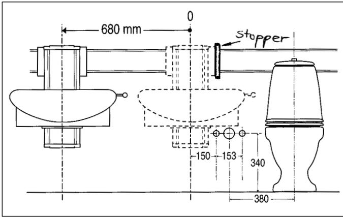
**Der Waschtischanschluß kann mit verschiedenen langen Schläuchen geschehen, die längsten erlauben seitliche Verstellungen bis zu 830 mm vom Warmwasser-Eckventil**
