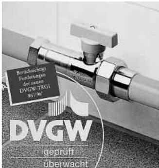
'86/'96. Das thermisch auslösende Absperrerelement sperrt die Gaszufuhr automatisch bei einer Umgebungstemperatur von 100 °C. Die geforderte Prüftemperatur von 650 °C wird deutlich überschritten und dehnt den Schutzzeitraum von 10 auf ca. 30 min. aus.
