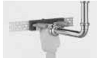
Siphon 310 von Dallmer. Wasserzu- und Wasserablauf sind normgerecht und platzsparend in einer Anschluß-Einheit zu kombinieren. Zum Lieferumfang gehören Siphon 1 1/4" x 50, schallgedämmte Montageplatte, zwei MS-Wandscheiben sowie eine Leifeld-Lochschiene. Die Montageplatte wurde so konstruiert, daß auch andere handelsübliche Wandscheiben montiert werden können.
