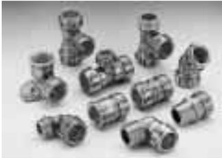
mutter mit einem Gabelschlüssel ist die Verbindung metallisch dicht. Im Versuch hält das System Drücken über 200 bar stand. Rohre verschiedener Werkstoffe (Weich- und Edelstahl, Kupfer) lassen sich in einem System ohne besondere Übergangsstücke kombinieren. Conex ist für alle Medien in der Hausinstallation geeignet und kann unter Putz verlegt werden.
