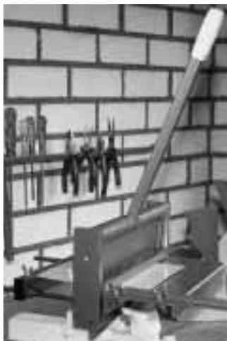
fertigt, der Niederhalter verhindert, daß sich das zu schneidende Materialstück aufrichtet. Bleche aus Stahl in normaler Härte lassen sich bis zu einer Dicke von 1 mm, aus Aluminium bis zu 2,3 und aus Kupfer bis zu 1,5 mm trennen. Als Zubehör sind Auflegetisch und Hinteranschlag erhältlich. Ersatzmesser sind jederzeit nachlieferbar.
