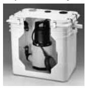
Bereich der Abwasserentsorgung von Ablaufstellen, die unterhalb der Rückstauebene liegen. Die in den Anlagen eingebauten Tauchpumpen werden über einen Schwimmerschalter gesteuert. Die Anlagen sind steckerfertig montiert. Zum Lieferumfang gehören neben der Anschlußmöglichkeit einer Waschmaschine, zwei separate Zuläufe DN 40, ein Aktivkohlefilter und eine in der Druckleitung integrierte Rückschlagklappe.
