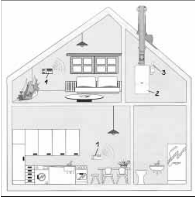
Der Sender im Raumtemperaturregler (1) meldet über die Antenne (2) die aktuelle Raumtemperatur an den im Heizgerät (3) montierten Empfänger
