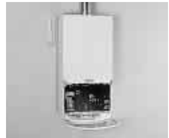
Der Sender im Raumtemperaturregler (1) meldet über die Antenne (2) die aktuelle Raumtemperatur an den im Heizgerät (3) montierten Empfänger
