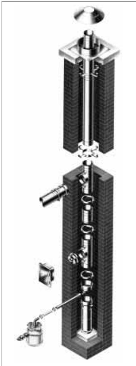
**Führt die Abgasleitung in mehrere Geschosse, muß der Brandschutz sichergestellt sein. Am sinnvollsten scheint hier die Abgasleitung aus nichtbrennbarem Material.**
