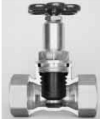
en Oberteil. Der Kolben aus EPDM wird durch zwei O-Ringe gegenüber dem Oberteilgehäuse abdichtet. Dadurch kann sich dort kein Wasser ansammeln und beispielsweise zu Legionellenwachstum führen. Auch Ablagerungen und Korrosion gehören der Vergangenheit an. Das Unterteil besteht aus Rotguß. Der Schieber ist in den Dimensionen DN 15–50 mit Muffengewinde oder Außengewinde in zwei Ausführungen erhältlich.
