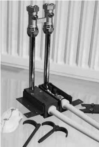
zungsrohr mit den Winkel-Anschlußbögen verbunden und in der Dose eingeklinkt. Dadurch ist die Heizungsanbindung zugentlastet. Die passenden Abdeckrosetten mit 50 mm Nabenabstand sorgen für sauberen Abschluß zum Bodenbelag. Und mit den neuen Dübelhaken wird das Heizungsrohr im Rohboden fixiert.
