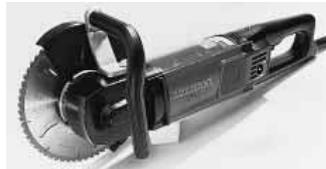
ten werden. Die meisten Oberflächenveredlungen werden nicht beschädigt. Das Trennen mit dem Kreissägeblatt stellt eine Fuge von 4 mm Breite her, wobei kaum ein Grat entsteht. Dadurch wird ein Nacharbeiten überflüssig und das Materialende kann ohne Zwischenschritte weiterbearbeitet werden. Auch dünne Bleche durchtrennt das Sägeblatt – ohne Verformung, wie der Hersteller versichert.
