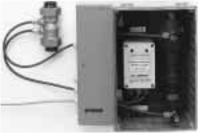
beck das Härtekontrollgerät Geno-control. Es verfügt über einen Härtesensor DN 20, der in die Meßwasserleitung eingebaut wird, und über Verbindungsleitungen zur Auswerteeinheit. Resthärten werden optisch und akustisch gemeldet. Der Betriebszustand kann auch über einen potentialfreien Ausgangskontakt an die zentrale Gebäudeleittechnik weitervermittelt werden.
