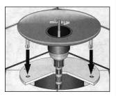
... Ist das Element beplant und verfliest, kann die Schutzkappe gegen die Abdeckrosette mit dem Druckknopf ausgetauscht werden
