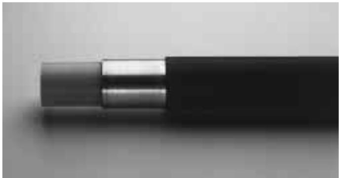
**Schichtenaufbau von Rohren aus PE-Al-Verbundwerkstoffen [4]**
