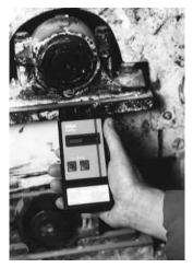
nester selbst bei stark verrauchter Umgebung innerhalb einer Reichweite von bis zu 30 Metern und kann diese mit dem optional erhältlichen Laserpointer markieren. Das Gerät eignet sich als Alternative zu Wärmebildkameras z. B. bei der Bestimmung der Position von Heizungsund Warmwasserleitungen im Mauerwerk.
