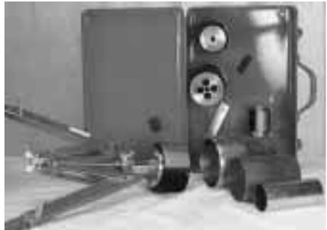
eine Muffenanformzange. Das Werkzeug wird im Metallkoffer geliefert, das neben der Zange mit den Teleskopgriffen die Segmente zum Aufweiten für die Durchmesser 60, 80 und 100 mm sowie eine Faltengabel zum Engermachen der Rohrenden enthält. Auf Wunsch können auch Segmente in den Durchmessern 76, 87 und 120 mm geliefert werden. Der genaue Durchmesser läßt sich über eine Flügelmutter einstellen. Da das Aufweiten durch Muskelkraft geschieht, ist kein Elektroanschluß erforderlich.
