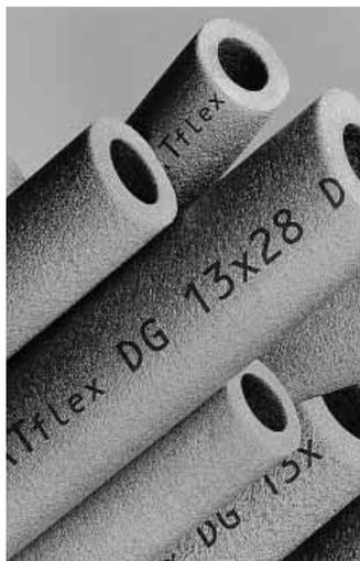
aus synthetischem Kautschuk. Das schwerentflammbare, FCKW-freie Material kann die Anforderungen der DIN 1988 erfüllen. Die Wärmeleitfähigkeit  $\lambda_R$  beträgt 0,040 gemäß HeizAnIV.
