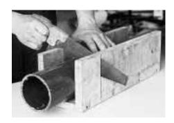
Rohrende glätten und auf 15° mit einer Kunststoff-Flachfeile oder – wie auf dem Bild – mit dem Anfasgerät anschrägen, um das Zusammenstecken zu erleichtern
