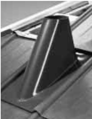
**Einfassungsplatten sind für Entlüftungsrohre von DN 80 bis DN 100 und Dachneigungen von 12 bis 50° werkseitig erhältlich**
