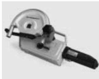
sätzen mit DIN/DVGW-gerechten Biegeradien vervollständigt diese Maschine. Eine automatische Endabschaltung gewährleistet den sofortigen und punktgenauen Stopp des Biegevorgangs beim Erreichen des eingestellten Biege winkels. Der Biegevorgang ist jedoch auch manuell steuerbar. Herzstück ist ein voll kugelgelagertes und stark untersetztes Power-Getriebe. Durch die Reduzierung von 32 000 auf nur 3 Umdrehungen pro Minute gewährleistet es ein hohes Übertragungsmoment für konstante Kraftübertragung.
