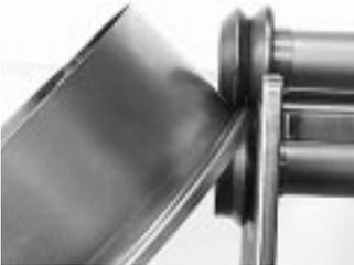
**. . . sowie sogenannte Kastenwalzen, mit denen sich Querfalze an Blech-Hohlkörpern vorbereiten lassen, wobei der Rand gleichzeitig geschweift und gebördelt wird**
