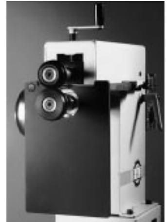
**Die Anschlagplatte von 240 mm Höhe bietet vor allem bei Hohlkörpern größeren Durchmessers sicheren Halt**
