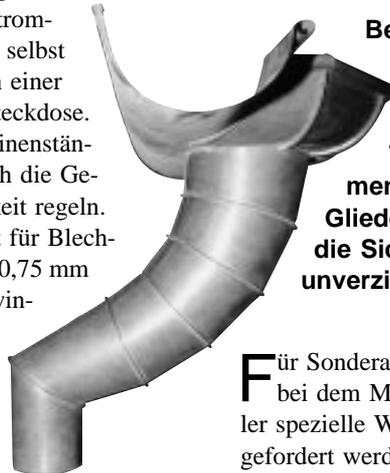
**Bei der Anfertigung dieses aus mehreren Teilen zusammengesetzten Gliederbogens war die Sickenmaschine unverzichtbar**
