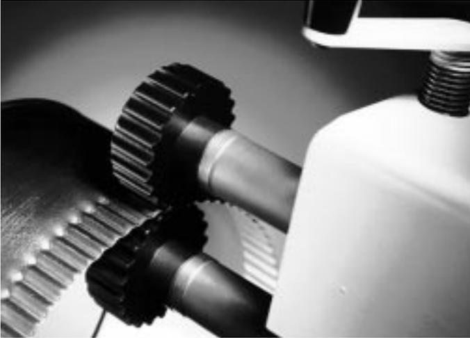
**Im Standard-Walzensortiment sind auch 20 mm breite Einziehwalzen zum Reduzieren des Blechrohr-Durchmessers enthalten . . .**
