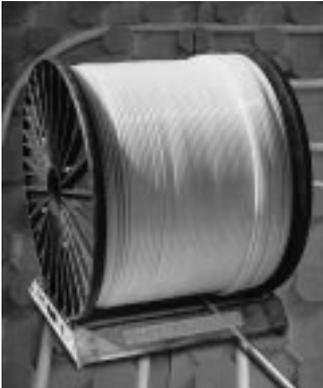
Knicks mit Warmluft bei maximal 140 °C aufgrund des Memory-Effektes dieses Materials wieder entfernen. Doch sicherer ist eine glatte und zügige Verlegung mit Hilfe von Rohrtrommeln und der zugehörigen Abrollvorrichtung, da es hierbei kaum zu Verdrehungen mit einem nachfolgenden Knicken des Rohres kommt. Zudem entlastet das Gerät den Installateur von schweren Transportarbeiten. Und durch die relativ große Rohrleitungslänge wird der Verschnitt auf ein Minimum reduziert.
