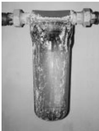
sierte. Die Verformung der Gewindemuffen des Geräteober-teiles deutet darauf hin, daß entweder die Verschraubungsstutzen zu stark eingehanft wurden oder daß es zum für viele Kunststoffe typischen „Kriechen“ kam. Der Zustand des Gerätes aber zeigt, daß es über längere Zeit weder vom Anlagenbetreiber noch von einem Installateur gesichtet worden ist. (Gesehen in Stuttgart in einem öffentlichen Gebäude)
