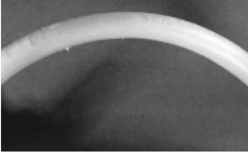
Die in Waschmitteln enthaltenen Tenside fördern die Spannungsrissskorrosion bei Rohren aus Polypropylen, wenn sie z. B. zur Geräuschdämpfung dem Heizungswasser beigemischt werden [1]
