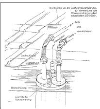
Das Kombirohr des Solar-Innovations-Systems gleicht einem Regenfallrohr, enthält jedoch Vorund Rücklauf des Solarkollektors. Lediglich im Aufstellungsraum des WW-Speichers muss ein Kernloch gebohrt werden (u.) sowie durch die Dachschalung (o.)
