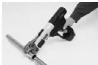
Signal angezeigt. Die Presszange bleibt bis zum Umschalten auf Rücklauf geschlossen. Für die erforderliche Leistung sorgt ein Akku mit 12 V und 2,0 Ah. Die Multi-Press wird als Basic-Pack inklusive Schnellladegerät (1 h) im stabilen Stahlblechkasten geliefert.
