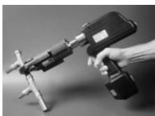
handy deckt alle Anwendungen ab, da Wechselpressbacken für die unterschiedlichen Rohrdurchmesser verwendet werden können.
