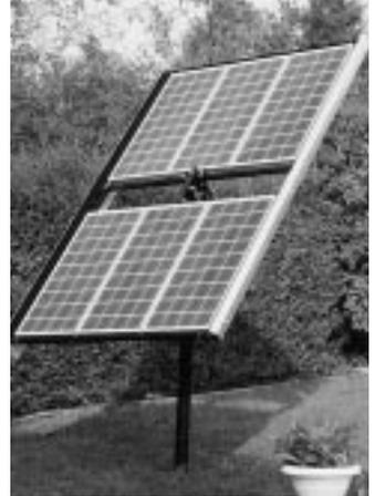
Energiezuführung der Sonne nachgeführt. Dies geschieht bei Sonneneinstrahlung durch die Gewichtsverlagerung einer Flüssigkeit von einer Halterungsseite zur andern. Zur Aufstellung wird zusätzlich ein Mast benötigt. Das System ist für Windlasten bis 120 kg/m<sup>2</sup> ausgelegt, wobei Stoßdämpfer für eine ruhige Lage bei starkem Wind sorgen. Morgens geht bei der ersten Sonneneinstrahlung das System automatisch aus der Abend- in die Morgenstellung zurück.
