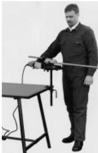
ge des Unternehmens mit allen Kupferrohren nach GW 392 in den Festigkeitsklassen hart, halbhart und weich ohne Gewährleistungseinschränkung verwendbar.
