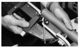
Gleichmäßig schiebt man nun den Dämmschlauch über Dorn und Beschickungsleiste, sodass der Schlauch geschlitzt und auf einer der Schnittflächen mit dem Klebestreifen versehen wird
