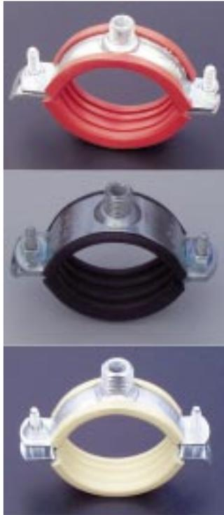
**Die Farben der Einlagen in Rohrschellen weisen auf das Material sowie den Einsatzbereich hin (v. o.): EPDM für –50 bis +110 °C mit 45° Shore-Härte, EPDM für –50 bis +110 °C mit 55° Shore-Härte (Gleitschelle), Silikon für –60 bis +200 °C mit 40° Shore-Härte (Schelle für Dampf- und Sprinklerleitungen) [2]**
