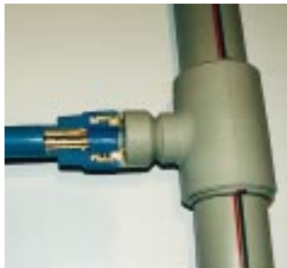
Das aufgeschnittene Modell des Übergangsadapters aus PE und PP aus dem Tersia-Programm von Rafeld, der per Heizelement mit PP-Fittings und – unter Zuhilfenahme einer Stützhülse – mit PE-X-Rohren verschweißt werden kann [3]
