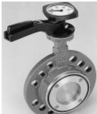
noch Rückflussverhinderung und Temperaturmessung hinzu. Die spezielle Bauweise ermöglicht das einseitige Abflanschen der Rohrleitung zu Wartungs- und Reparaturarbeiten bei vollem Betriebsdruck. Die Klappe ist in den Nennweiten von DN 50 bis DN 200 erhältlich und für Betriebsdrücke bis 16 bar, bzw. 10 bar statischem Druck, geeignet. Der Flanschanschluss erfolgt wahlweise nach DIN 2631/32/33 oder ANSI 150.
