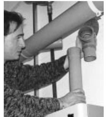
gewährleisten das dichte Verschießen der Abgasleitung derjenigen Feuerstätte, die nicht in Betrieb ist. Durch das individuelle Betriebsverhalten der Brennwertkessel in Verbindung mit der Rückströmsicherung ist eine gemeinsame Prüfung erforderlich. Für den Einsatz bei der Etagenheizung wird eine konzentrische Ausführung entwickelt.
