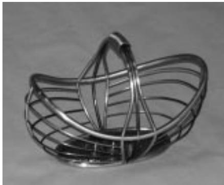
Nahezu alle Rundungen des Fruchtkorbes können per Hand gebogen werden, lediglich für die kleinen Radien des Bodenrahmens ist die Verwendung eines Handbiegegerätes zu empfehlen
