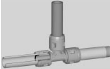
**Grundkörper und Hülse des Multi-Fittings sind aus PSSU gefertigt, die speziell geformte Dichtung aus EPDM, der Krallenring aus Cr-Ni-Stahl**
