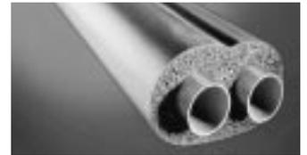
gesetzt werden. Die Wärmeleitfähigkeit des UV- und witterungsbeständigen Materials liegt bei 0,040 W/mK. Mit dem Produkt, das in drei Dimensionen und einer Dämmschichtdicke von 14 mm angeboten wird, können beispielsweise Vor- und Rücklaufleitungen von Solaranlagen gedämmt werden. Für die leichtere Verlegung von Steuerschleifen ist es mit einer Nut versehen. Im Brandfall ist der zur Brandklasse B2 zuzuordnende Werkstoff selbstverlöschend, tropft nicht ab und leitet kein Feuer weiter.
