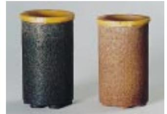
**Eine dunkle Verfärbung der Filteroberfläche (l.) ist kein Indiz für verschmutztes Heizöl (Bild: Shell/PAE-Labor)**
