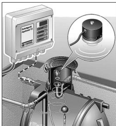
gesichertem Überlaufanschluss ans Kanalnetz erfolgt eine optische und akustische Rückstaumeldung bei gleichzeitiger Umstellung der Leitungsver-sorgung auf Trinkwasser, um das Eindringen von Schmutzwasser zu verhindern.
