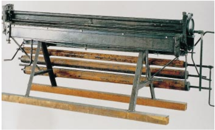
Den ersten großen Erfolg erzielte Firmengründer Josef Schechtl mit der Handabkantmaschine KS 1 für „die Ausführung sämtlicher Bauklempnerarbeiten“
