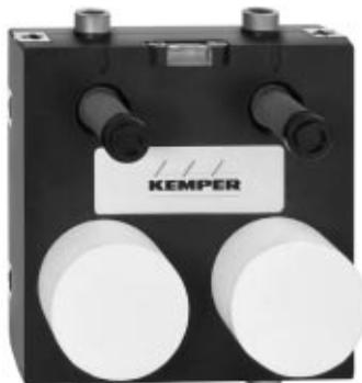
Libelle integriert. Beide Blöcke sind erhältlich für Wasserzähler von Spanner-Pollux, Allmess, Deltamess und EAS. Das Stichmaß zwischen Ventil und Zähler beträgt 153 mm, sodass sich der Block an das Fliesenraster anpassen läßt. Die Kombination ist auch ohne Umman- telung erhältlich.
