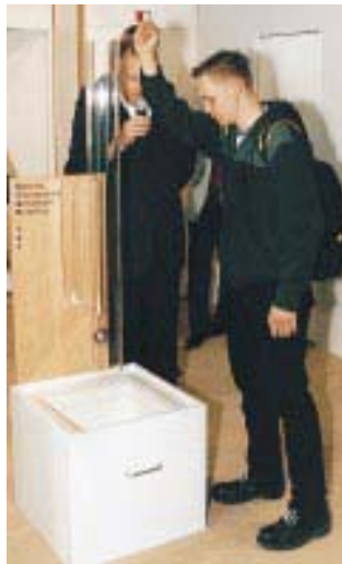
Die Stahlkugel, die der Berliner Berufsschüler auf die „Glas“platte vom Typ Star-Tec fallen ließ, hatte keine zerstörende Wirkung (Düker)
