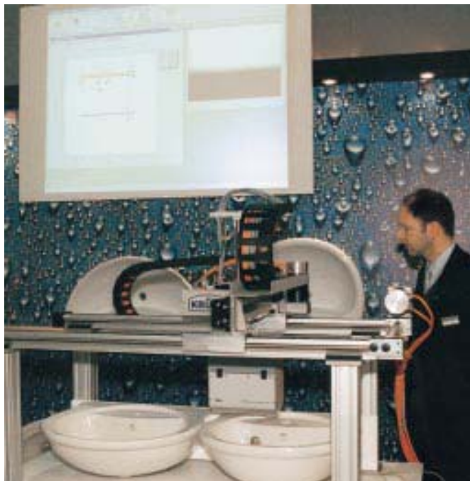
Prüfung des Benetzungsverhaltens von behandelten und unbehandelten Oberflächen keramischer Einrichtungsgegenstände (Krüss/Ideal Standard)
