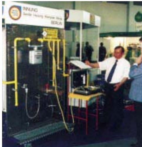
Für die Sicherheitsprüfung „Gas – ganz sicher“ wurde ein Übungsstand entwickelt, an dem die Leckmengenmessung auch bei verschiedenen Leitungsvolumen möglich ist (Innung SHK Berlin)
