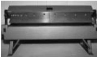
und das größte 80 bzw. 160 mm, je nach der Maschinenbreite. Zugelassen sind beide Geräte bis zu einer Materialstärke von 1,0 mm Stahl- und 1,5 mm Aluminiumblech. Mit ihnen sind Abkantungen bis 135° möglich.
