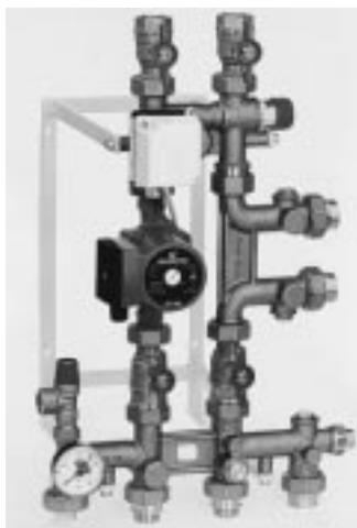
mengefasst. So sind Heizungsumwälzpumpe, 3-Wege-Umschaltventil, Überströmventil und Absperrarmatur auf einem Abstandhalter angebracht, der über der Wärmepumpe an die Wand geschraubt wird. Die Anschlüsse fluchten genau mit denen der Wärmepumpe, sodass die Anschlüsse nur noch verschraubt werden müssen. Der Pufferspeicher Vitocell 050 wird direkt an die Divicon angeschlossen.
