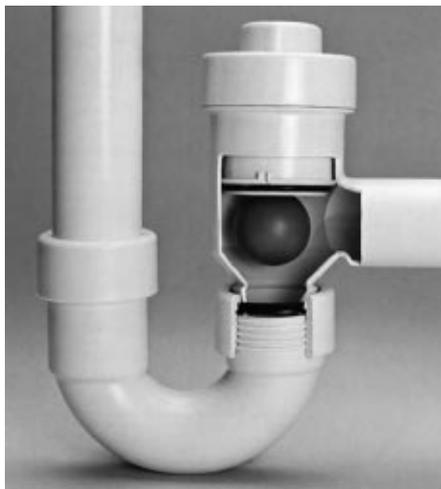
Selten benutzte Ablaufstellen unter der Rückstauenebene können über absperrbare Geruchverschlüsse gesichert werden. Das abfließende Wasser drückt die Kugel hoch, rückfließendes Wasser drückt sie in den Sitz
